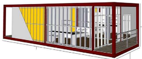
รูปที่ 2 ตัวอย่างโมดูลาร์ที่ถูกใช้เป็นโครงสร้างอาคาร
