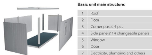
รูปที่ 4 ตัวอย่างโมดูลาร์ที่สามารถถอดประกอบได้ เพื่อประโยชน์ในการขนส่ง
