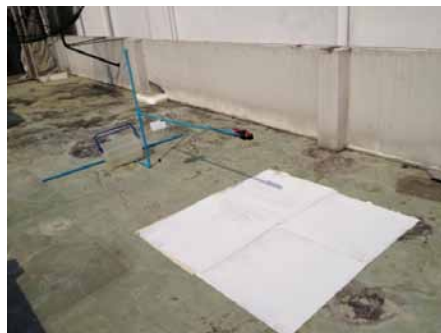
รูปที่ 2 ภาพการทดลองการหาค่าการสะท้อนความร้อนจริง
