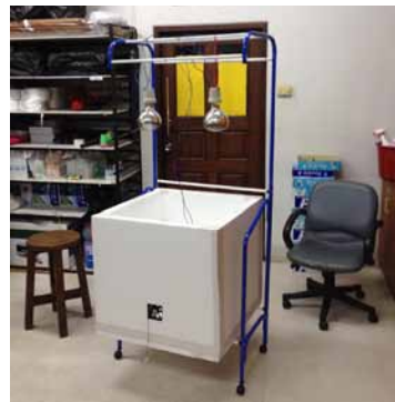
รูปที่ 4 ภาพการทดลองหาค่าความต้านทานความร้อน
