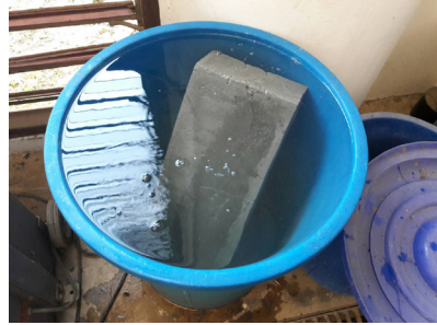
3. นำไปแช่น้ำเป็นเวลา 30 นาที และ 24 ชม. ตามลำดับเพื่อทดสอบการดูดซึมน้ำ
