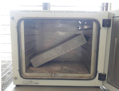
2. นำไปอบที่อุณหภูมิ 110 องศาเซลเซียสเป็นเวลา 24 ชม. เพื่อทดสอบความหนาแน่นแห้ง
