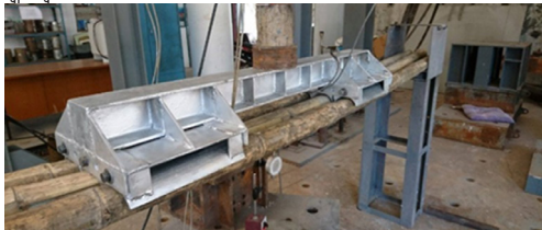
รูปที่ 4 ทำการทดสอบที่ (1/3)L ของความยาวลำไผ่
