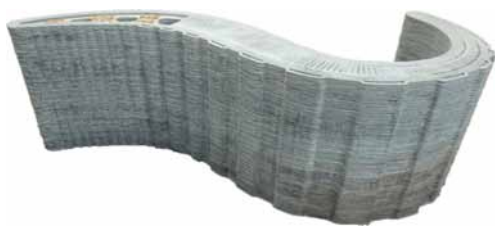
ที่มา: Freeform Construction, 2015 รูปที่ 1 ชิ้นงานที่ขึ้นรูปด้วยการพิมพ์ระบบ FDM
