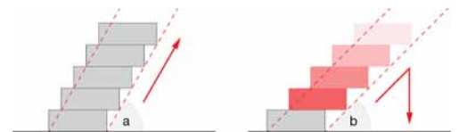
รูปที่ 10 รูปทรงที่ยื่นออกจากฐานในองศา a (ซ้าย) ที่จะไม่พังทลาย และองศา b (ขวา) ที่จะพังทลาย
