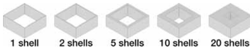
รูปที่ 6 เปลือก (shell) ที่มีจำนวนชั้นแตกต่างกัน
