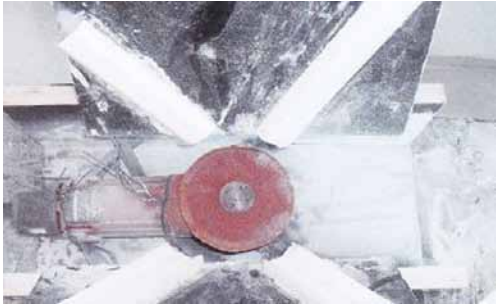
ที่มา: บริษัทแกรนด์ ยูนิตี้ ดีเวลลอปเม้นท์ จำกัด รูปที่ 4 เครื่องตัดมอมผ้าเพดานครั้งเดียวได้ 4 ชั้น
