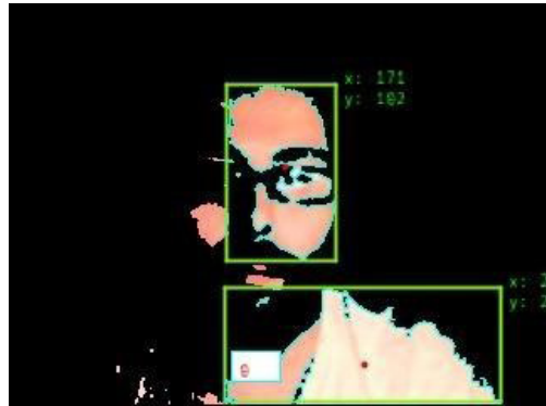
รูปที่ 5 การตรวจจับกลุ่มพิกเซลของคน โดย Library Blob Detection ของ Processing
