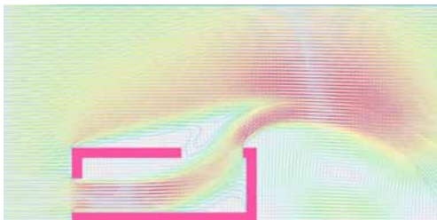
รูปที่ 8 การจำลองสถานการณ์การไหลผ่าน ผนังอาคาร แสดงผลเป็นเส้นและสี
