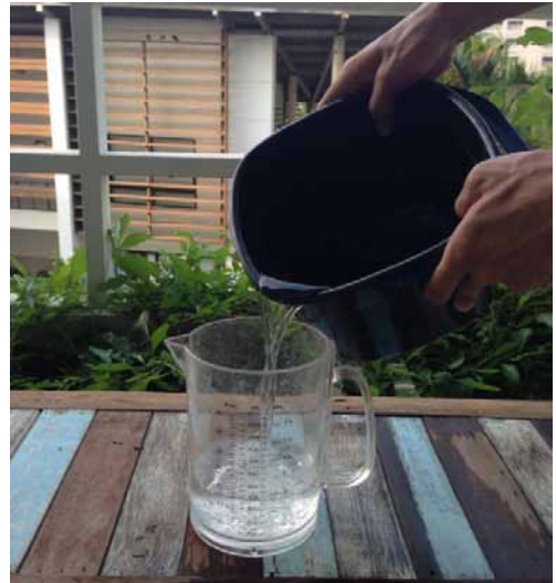
รูปที่ 1 การเก็บน้ำทิ้งจากระบบปรับอากาศและนำมาตวง
