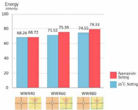
รูปที่ 6 เปรียบเทียบค่าการใช้พลังงานของการตั้งค่าอุณหภูมิเครื่องปรับอากาศที่ 25°C และการตั้งค่าอุณหภูมิเครื่องปรับอากาศเพื่อรักษาสภาพน่าสบาย
