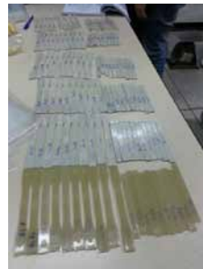
รูปที่ 5 ชิ้นทดสอบที่ขึ้นรูปแล้วเสร็จ
