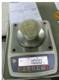
รูปที่ 4 การชั่งตวงวัสดุและผสมตามอัตราส่วนที่กำหนดไว้ข้างต้น
