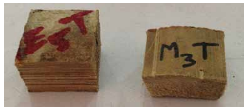
รูปที่ 1 ตัวอย่างไม้ตงในการทดสอบความชื้น ซ้าย: ไม้ตงจากอุบลราชธานี ขวา: ไม้ตงจากปราจีนบุรี
