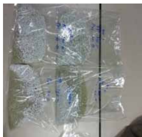
รูปที่ 4 การชั่งตวงวัสดุและผสมตามอัตราส่วนที่กำหนดไว้ข้างต้น
