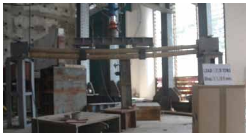
รูปที่ 4 การรวบลำไ้ที่มีระยะห่างของการเชื่อมต่อ 1/3 ของความยาวคาน บริเวณจุดที่ถ่ายน้ำหนักลงตรงจุดเชื่อมต่อของลำไ้
