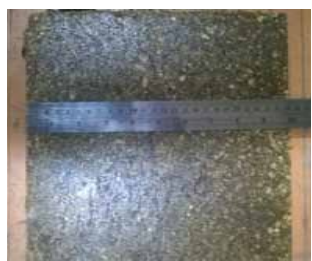
รูปที่ 6 ชิ้นตัวอย่างเมื่อนำออกมาจากเครื่องอัดความร้อน
