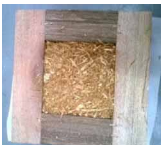
รูปที่ 4 การขึ้นรูปก่อนนำเข้าเครื่องอัดความร้อน
