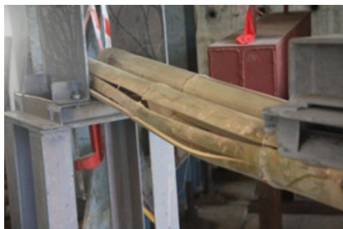
รูปที่ 3 ลักษณะการวิบัติแบบ Splitting
