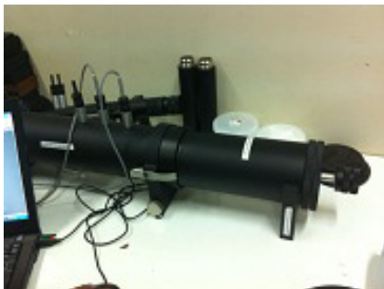
รูปที่ 9 เครื่องทดสอบคุณสมบัติการดูดซับเสียง (Acoustic Material Testing)
