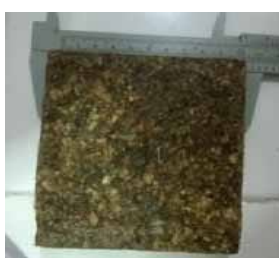
รูปที่ 7 ขนาดของแผ่นตัวอย่างเพื่อการทดสอบ กว้าง 10 ซม. 10 ซม. สูง 1.5 ซม.
