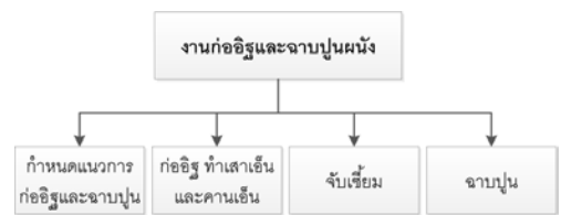
รูปที่ 2 กิจกรรมก่อสร้างในงานก่ออิฐและฉาบปูน
