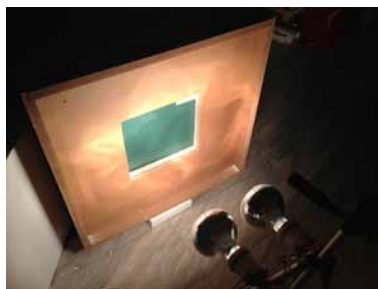
รูปที่ 2 ภาพขณะทดลองเปิดไฟส่องกระจกที่กล่องทดลอง
