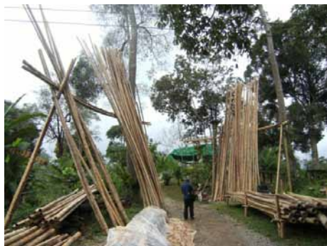
ที่มา: จากการ Workshop ที่อำเภอแมริม จังหวัดเชียงใหม่ รูปที่ 25 ไม้ไผ่ที่ผ่านการแช่น้ำแล้วมาผึ่งลม
