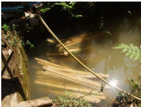
ที่มา: http://www.kaiteetua.com/plus7/data/00583-1-1.html รูปที่ 24 วิธีนำไม้ไผ่มาแช่น้ำ
